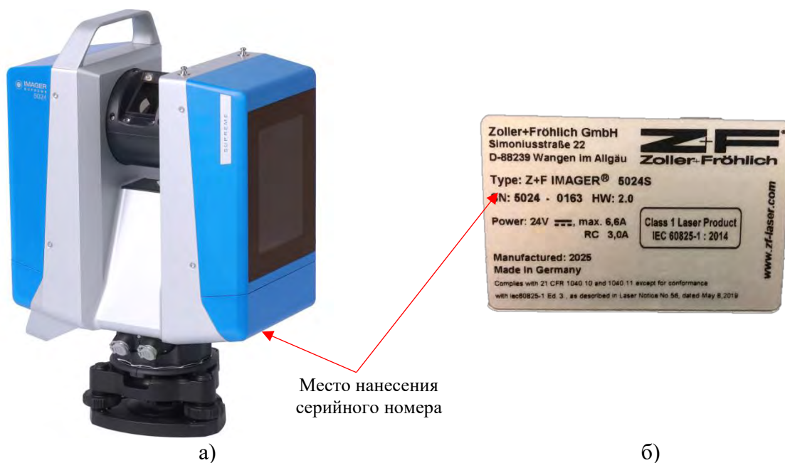
Рисунок 1 – Общий вид сканера и место нанесения серийного номера (а), а также внешний вид идентификационного шильда с серийным номером (б)
